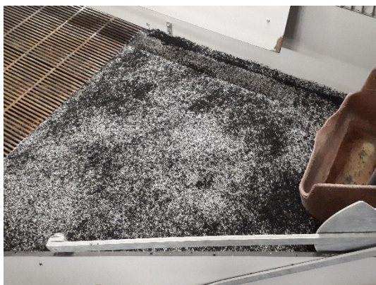
Gruppe 3: Overfladebehandling fra Kem Tek (polyuretan epoxy og gummigranulat)
